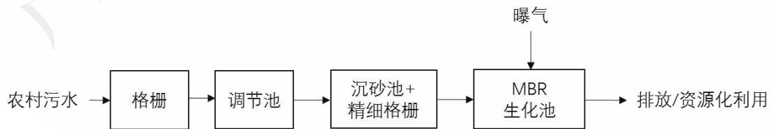
图 6.3.25 MBR 工艺流程图
